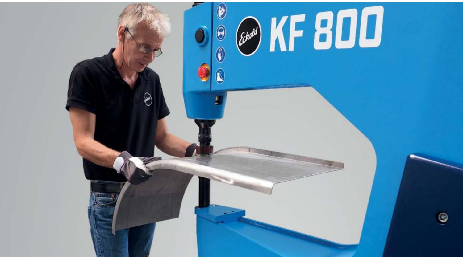
ECKOLD Umformen bedeutet Profile biegen, Bleche umformen, neue Teile anfertigen, Reparaturen ausführen und feinfühligste Korrekturen machen. Es wird ohne Wärme, genau, leise und spanlos gearbeitet. Diese Technik ist in ihrer Art weltweit einzigartig. ECKOLD bietet eine Palette von Kraftformer Maschinen an, die sich in Umformleistung, Ausladung, Hubzahl und Drucksteuerung unterscheiden.
